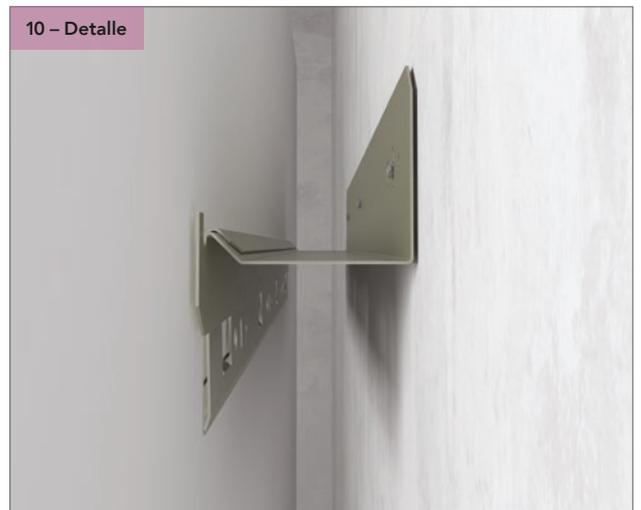
Coloque su absorbente mural Rockfon Eclipse en el perfil de fijación de la pared y ajuste el espaciador hasta que el panel mural Rockfon Eclipse esté nivelado. Vea 10 - Detalle.
