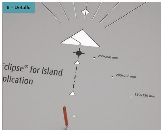
El punto en la base del triángulo debe colocarse en el punto medio de su marcado. La línea que marca el ángulo debe estar en la línea de 0° de la plantilla.
