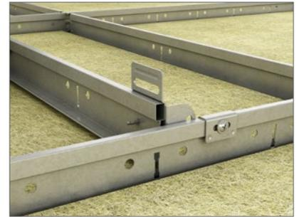
Para instalar la función de puente del soporte, simplemente atornille el soporte de puente y pared para perfiles en T a los perfiles primarios y secundarios, transfiriendo el peso de la instalación a la perfilera. Esto asegura que no haya carga en el panel, eliminando los problemas de flexión.
