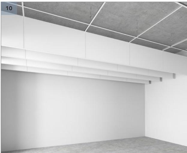
Fije los Rockfon Universal Baffles restantes a la perfilera T24 y alinéelos utilizando las perforaciones en el extremo de los baffles.
