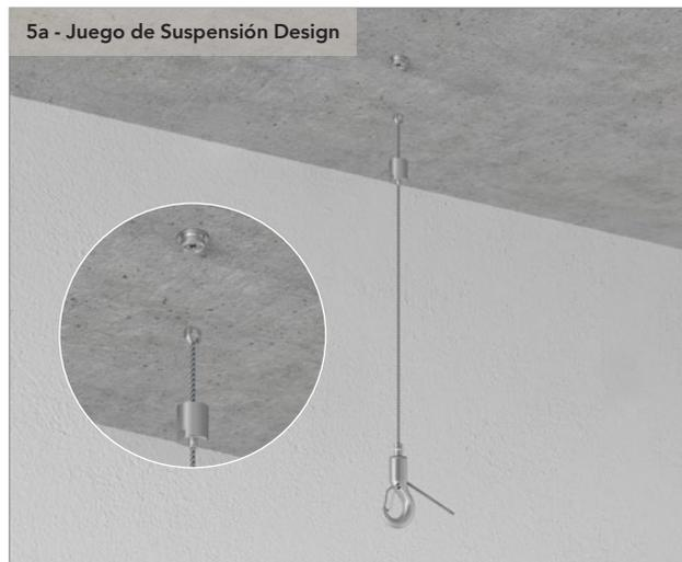
Deslice el cable de alambre del Juego de Suspensión de Diseño a través de la cubierta cilíndrica, de modo que el ojal del extremo del cable quede oculto en su interior. Atornillelo en la rosca M13. Puede acoplar el gancho ajustable al extremo inferior del alambre.
