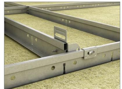
Para instalar la función de puente del soporte, simplemente atornille el soporte de puente y pared para perfiles en T a los perfiles primarios y secundarios, transfiriendo el peso de la integración de su servicio a la paerilería. Esto asegura que no haya carga en el panel, eliminando los problemas de deflexión.
