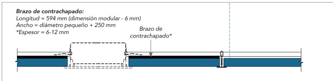
\* El espesor del brazo de contrachapado debe adaptarse según el peso, el tamaño y la posición de los materiales (como foco o altavoz). El brazo de contrachapado no debe doblarse después de la instalación de los materiales.
