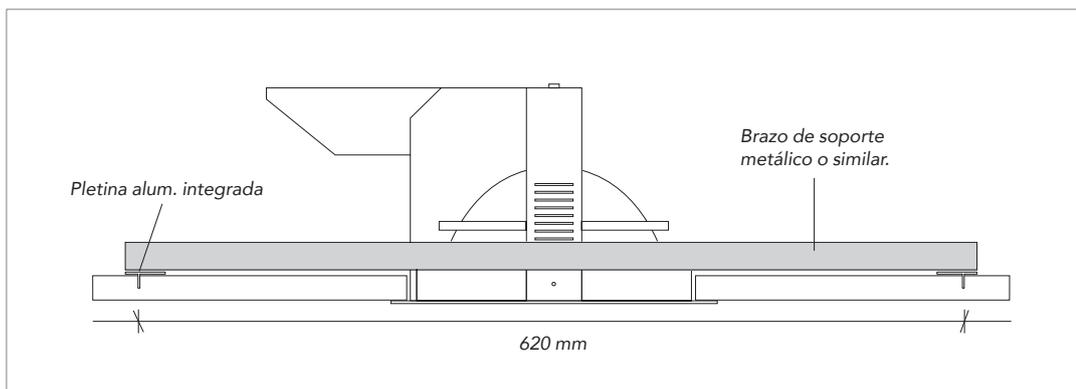
Esta solución es aplicable a luminarias (u otros servicios) cuyo peso sea de 5 kg. Sujete la luminaria con dos brazos de soporte, colocados sobre los perfiles de aluminio.
