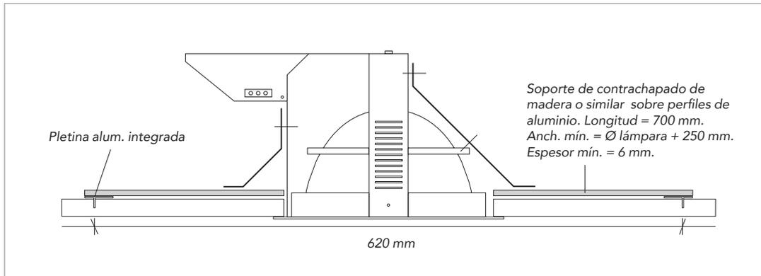
Esta solución es aplicable a luminarias (u otros servicios) y soportes de montaje cuyo peso sea de 5 kg. Practique un orificio en la isla y centre el soporte de montaje, según el tamaño y la forma de la luminaria.
