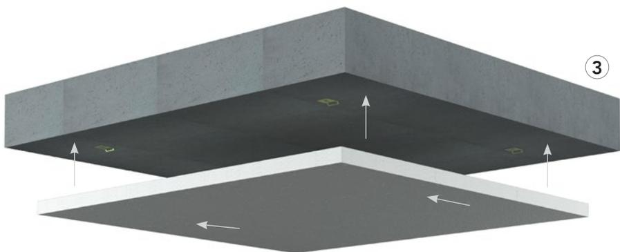
*Levante el panel hasta el soporte de hormigón e introdúzcalo en las abrazaderas.*
