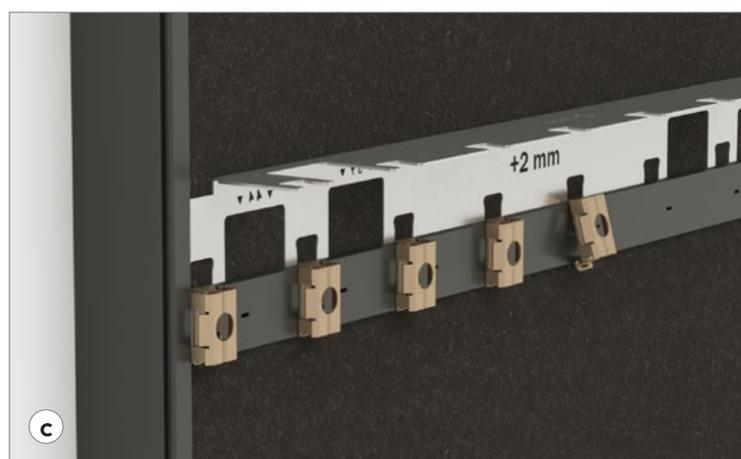
Una vez el primer Clip de Montaje esté colocado correctamente, coloque la Plantilla (utilizando el lado de +2 mm) en el primer Clip de Montaje (c) y coloque los siguientes Clips de Montaje hasta que el orificio de alineación del perfil de montaje horizontal y el orificio de alineación (el recorte) de la Plantilla estén alineados. A continuación, mueva la Plantilla hasta el extremo opuesto/final (a) y repita la operación en la otra dirección.
