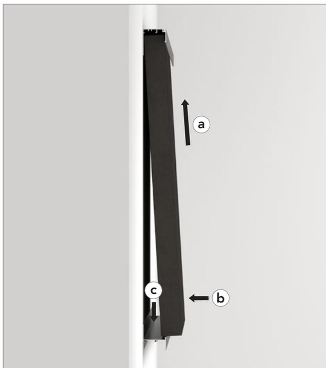
Deslice el Panel Fonoabsorbente en el perfil superior (a), empuje la parte inferior del Panel Fonoabsorbente hacia la pared (b) y déjelo caer detrás de la cara frontal del perfil inferior (c).
