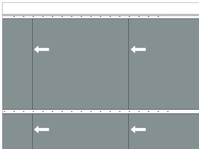
Deslice todos los Paneles Fonoabsorbentes Charcoal para que queden juntos.
