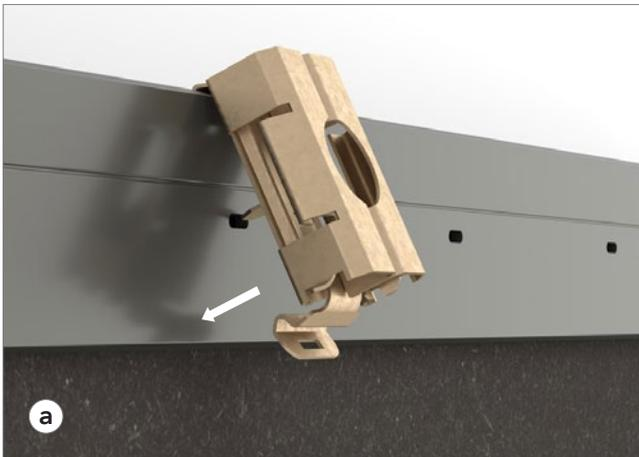
Fije los clips de montaje restantes utilizando las ranuras de alineación. Enganche los Clips de Montaje Rockfon Lamella en los perfiles horizontales. Alinee la pestaña de la parte posterior del Clip de Montaje con la ranura de la cara frontal de los perfiles horizontales.
